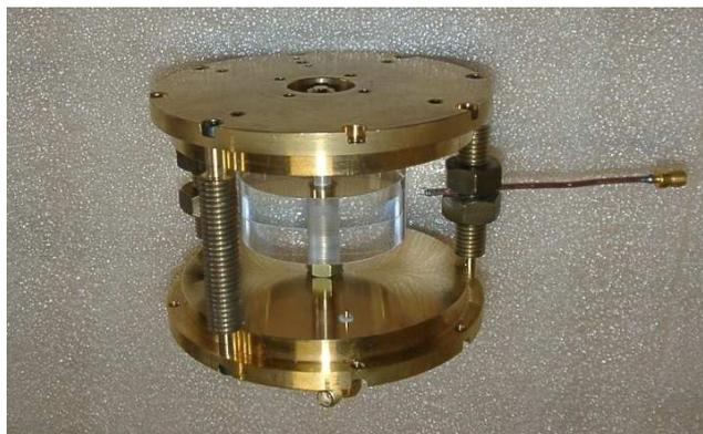
FIG. 3.4 – Premier prototype de cavité.
