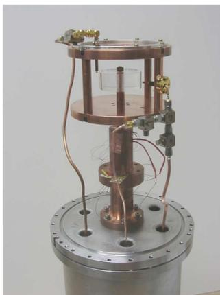
FIG. 4.16 – Photographie du contenu de l'insert cryogénique.
