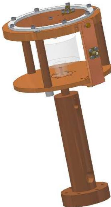
FIG. 3.8 – Prototype de cavité pour les nouveaux résonateurs.
