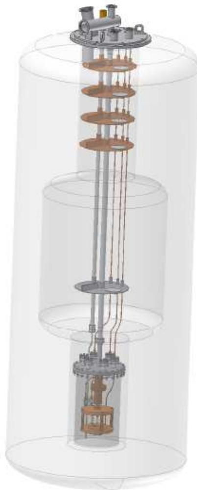
FIG. 3.2 – Représentation de l'insert cryogénique dans le cryostat.
